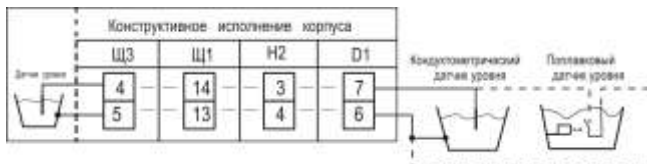
Схема подключения датчика уровня к терморегулятору РАТАР-02М.ТС
