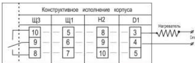
Схема подключения терморегулятора РАТАР-02М.ТС с релейным выходом
