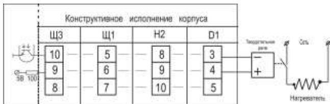
Схема подключения терморегулятора РАТАР-02М.ТС с транзисторным выходом
