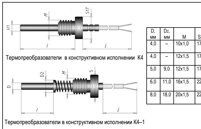
Рисунок 1 – Термопреобразователи сопротивления ТСPr и TCMr в конструктивном исполнении K4
