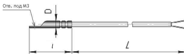
Рисунок 1 – Термопреобразователи сопротивления ТСPr и TCMr в конструктивном исполнении K5
