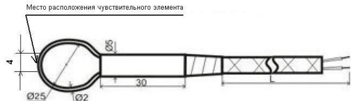
Рисунок 1 – Термометр сопротивления платиновый в конструктивном исполнении К20
