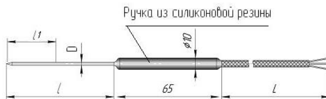
Рисунок 1 – Термопреобразователи сопротивления ТСПг и ТСМг в конструктивном исполнении К1И
